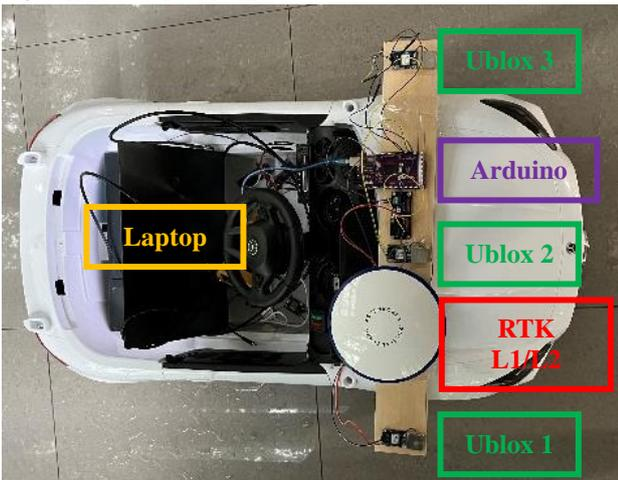
(그림 3) 3 개의 ublox-7M-NEO 와 Arduino Mega 를 연결한 제안 모델과 Ascen Korea RTK L1/L2, AKN940LTE 를 적재한 RC 카
