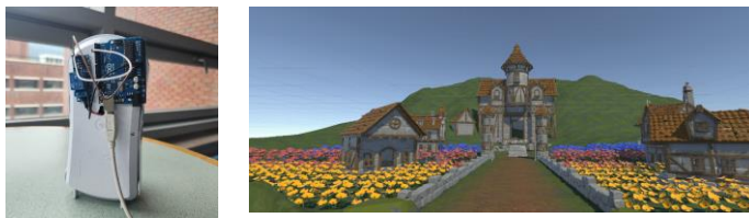
<그림 3> 후각 자극을 위해 제작된 분사 디바이스(좌)와 분사 시점의 콘텐츠 화면(우)
