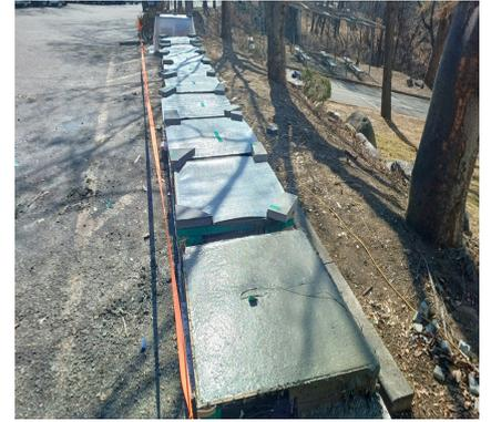
사진 1. 콘크리트 타설 후 모의부재
