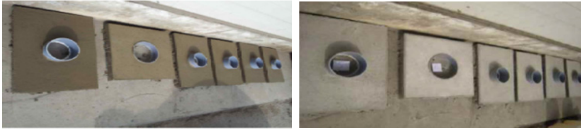
그림 1. 폐섬유 및 일반 보강섬유별 균열도 시험
