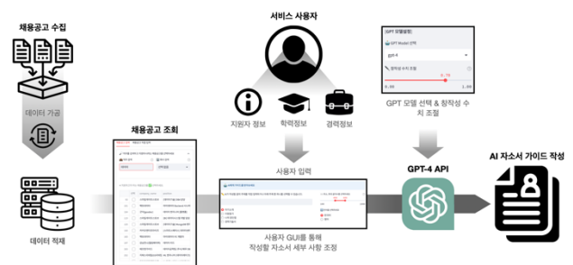
(그림 1) GPT-4 채용공고별 자소서 가이드 서비스의 end-to-end 시스템.
