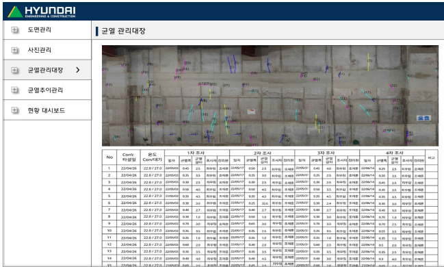
그림 1. 실내 골조 균열 모니터링 시스템 화면
