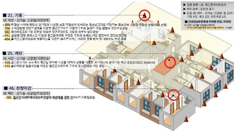
그림 3. BIM 객체별 적용 가능 건설신기술 정보 도출 결과 예시
