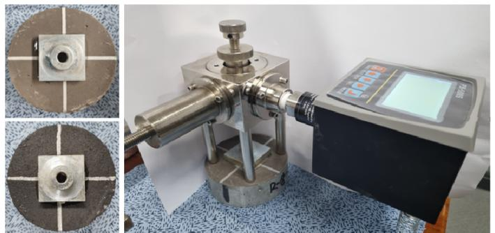
그림 1. 인장 접착 강도 측정 시험
