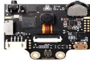
(그림 2) 적용된 센서(AI 비전카메라)[1]
