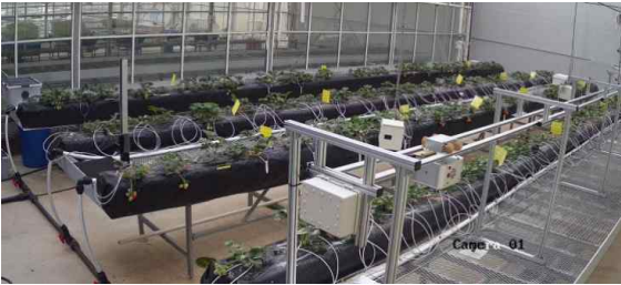
[그림 5] 조사각도 조절장치 적용 영상촬영시스템 (딸기 농장)
