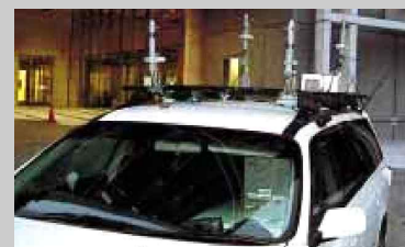
그림 9. NHK의 이동 HDTV 테스트용 다이버시티 수신 안테나
