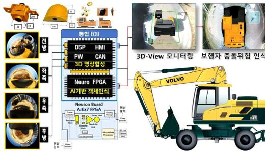
Fig. 1. 차세대 충돌 경고 시스템 개요도
