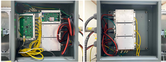
그림 2. 개발된 후방산란 엑스선 영상획득을 위한 다채널 검출기의 신호처리 및 전달 모듈
