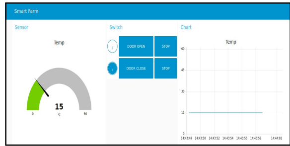
Fig. 8. 온도값 표시와 모터 On/Off 동작 모습
