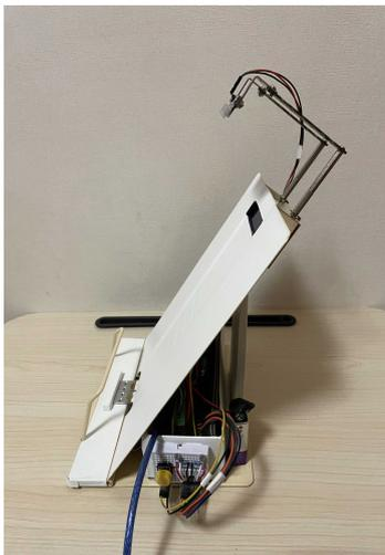
무게 센서가 부착된 수북 홀더는 자동으로 책의 무게를 인지하여 간편하게 시간을 측정할 수 있다. 독서 시간을 타이머로 측정하여 LCD 판에서 확인이 가능하고 블루투스 통신을 통해 시간 데이터를 전송한다. 또한 조도 센서를 통해 어두운 곳에서 책을 읽을 때 자동으로 조명이 on/off 되도록 한다.
