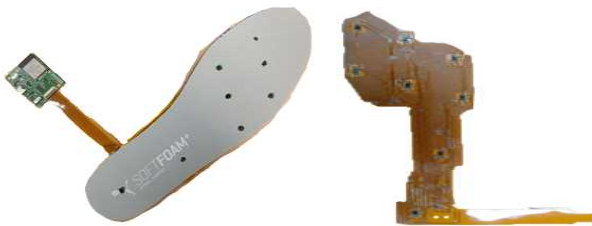
<그림 1> 완성된 IoT 깔창 기기 및 내부 pcb
