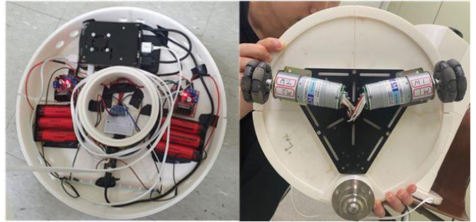
[그림 6] 로봇 내부 부품 및 구동부
