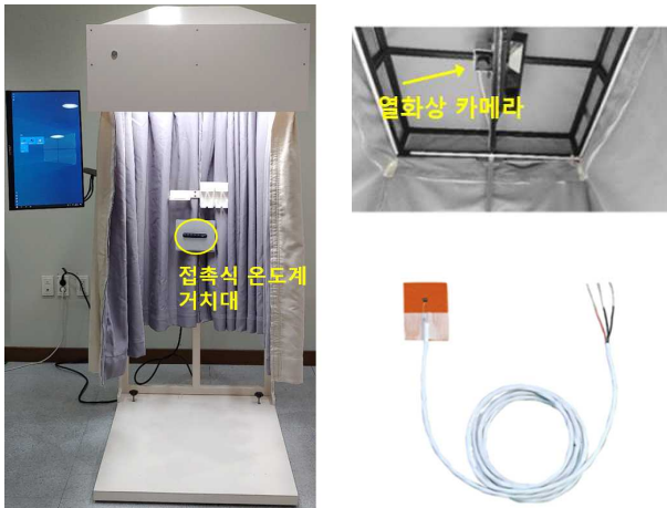
(그림 2) 복부 측정 장치 전체 구조, 내부, 접촉식 온도계
