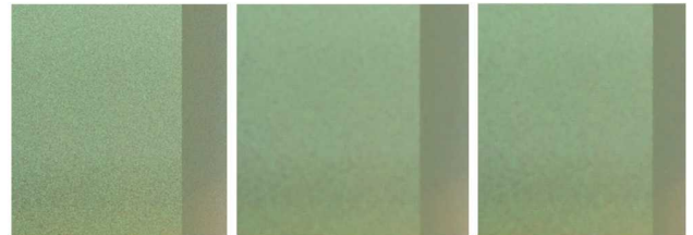
(그림 3) 노이즈 제거 결과 이미지, 왼쪽부터 노이즈 제거 전, median filtering 결과 이미지, Harris corner 검출법을 함께 사용한 median filtering 결과 이미지
