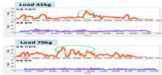
(그림 6) 로봇 장착 전 후 힘 측정 그래프
