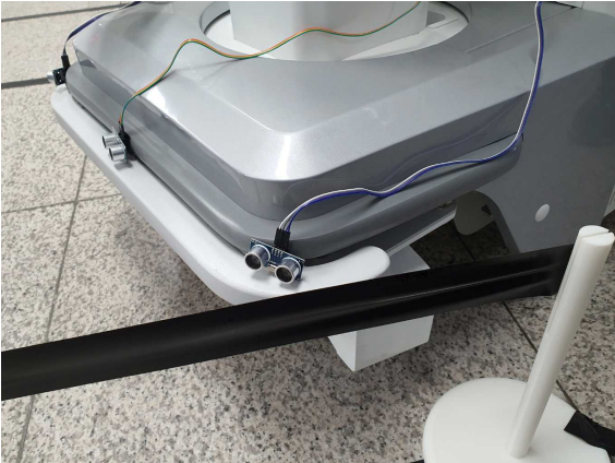
[그림 1] 이동형 X선 장비에 부착된 초음파 센서와 라인트레이서가 통합 구동하게 하였다.
