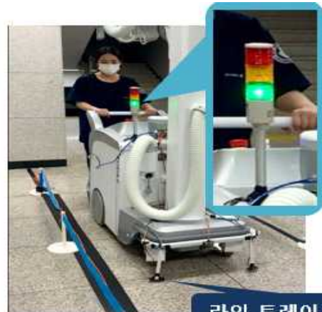
[그림 5] 최종 구현된 이동형 X선 장비 교육용 보조 시스템
