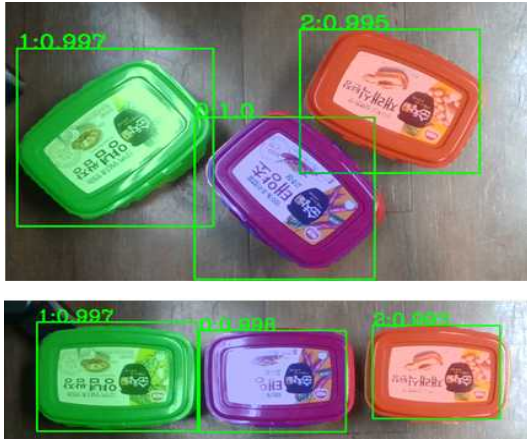
(그림 2) 전통장류 물체 종류 및 영역 인식 결과 좌측 숫자는 종류(라벨)를 의미하며 우측 숫자는 확률 값임.
