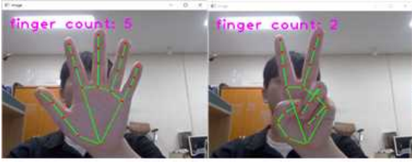
그림 7. Finger Counting using Hand Tracking
