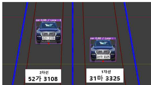
그림 7. 다차선 차선/차량번호 예상 검출 결과
