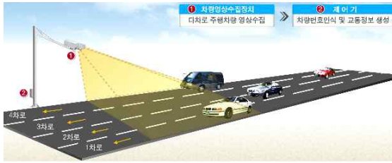
그림 1. ANPR 시스템의 전체구성도[4]
