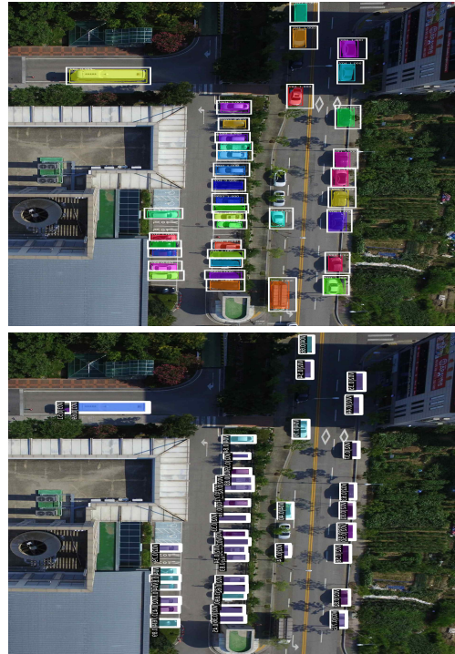
그림 1. 가중치 모델을 이용한 검출 결과 (위) 기존 Mask R-CNN (아래) Swin Transformer Fig. 1. Final output of model (Top) Mask R-CNN (Bottom) Swin Transformer
