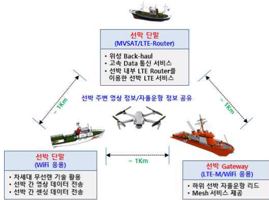
그림 2. 드론을 활용한 선박 센서 네트워크 구성
