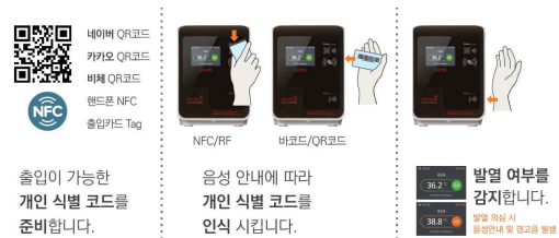
그림 3. 스마트 출입관리 시스템 개인인식 및 발열 확인 방법
