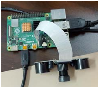
그림 8. 연구에 사용된 YR-030 적외선 카메라 모듈과 Raspberry Pi의 조합 상태
