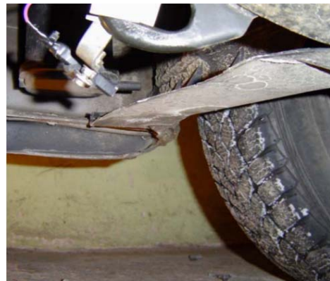
그림 2. 차량의 타이어 부근에 설치한 마이크로 소음측정[7]
