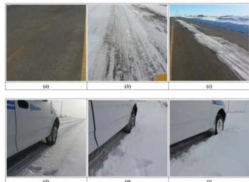
그림 3. 도로의 상태 및 적설량의 차이와 타이어 회전차의 차이점[8]
