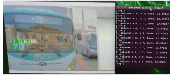
그림 5. YOLOv5로 버스번호 검출 화면과 검출속도 테스트 결과 (Jetson Nano)
