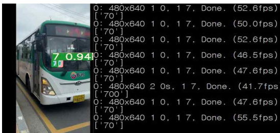
그림 4. YOLOv5로 버스번호 검출 화면과 검출속도 테스트 결과 (PC)
