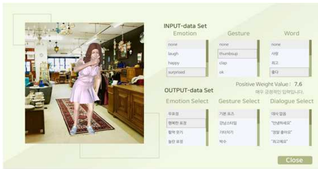
(그림 2) 가상 휴먼 저작 도구: 가상휴먼 및 백그라운드 이미지 선택(위), 사용자-가상 휴먼 간 입출력 정의(아래)
