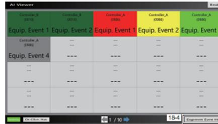
그림 7. 임계값 범위에 따른 경고 표시
