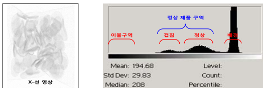
그림 1. 밀도차이를 이용한 이물 검출
