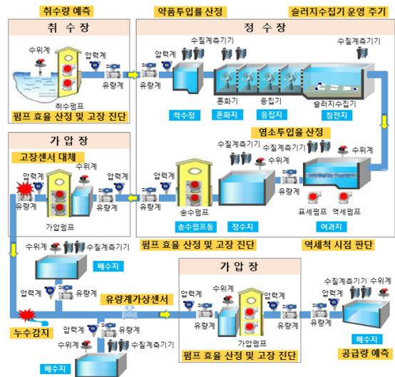
그림 2 수도사업장 AI 기반 복합센서 적용 예시
