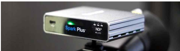
<그림 5> HDMI → NDI의 IP 방식으로 컨버팅해주는 Spark Plus 4K
