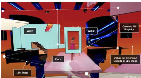
그림 1. XR시스템 구동 원리
