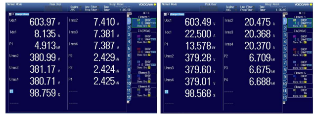
그림 5 전력모듈 적용 인버터 최대효율 (a) 해외 선진사, (b) 국내 개발품 Fig. 5 Maximum efficiency of power module applied inverter (a) Vincotech, (b) EcoSemitek
