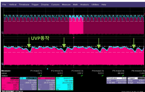
그림 3. LED 55" TV에서의 실제 UVP동작 파형
