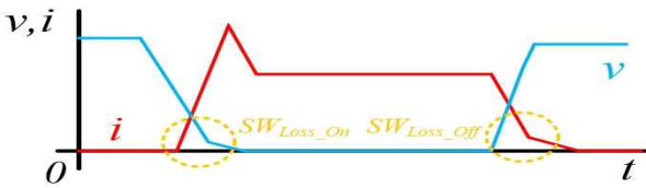
그림 4 소자의 스위칭 상태에 따른 전압 전류 파형 Fig. 4 Switching waveform of voltage and current
