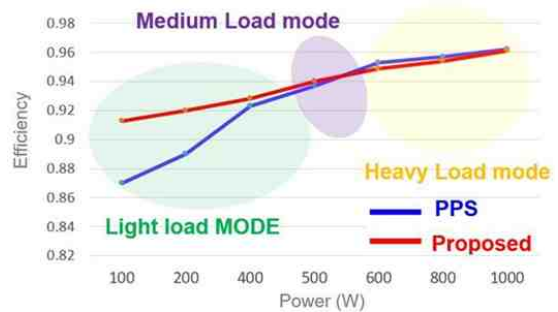
그림 9 전류원 DAB 컨버터 효율 그래프 ( V_{ESS}=40V ) Fig. 8 CF-DAB Converter Efficiency Curve
