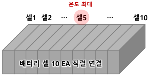
그림 2 배터리 열 모델링을 위한 배터리 팩 구조 Fig. 2 Battery pack structure for thermal modeling.
