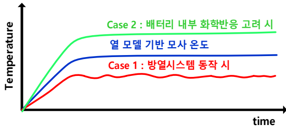
그림 7 방열 시스템 동작 또는 화학 반응에 의한 배터리 온도 변화 Fig. 7 Temperature change due to cooling or chemical reaction.
