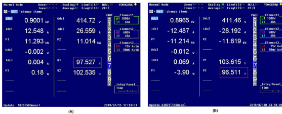
그림 7 효율 데이터 (A) 충전모드 입력:900V, 출력:413V, 출력: 11kW 조건 효율 데이터 (B) 방전모드 입력:413V, 출력:900V, 출력 11kW 조건 효율 데이터
