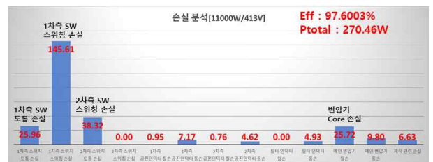
그림 5 입력 900V, 출력 413V, 11kW 부하 조건 손실분석 결과
