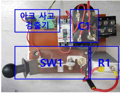
그림 2 태양광 DC 직렬 아크 사고 검출 시스템 사진 Fig. 2 Picture of a photovoltaic DC series arc fault detection system
