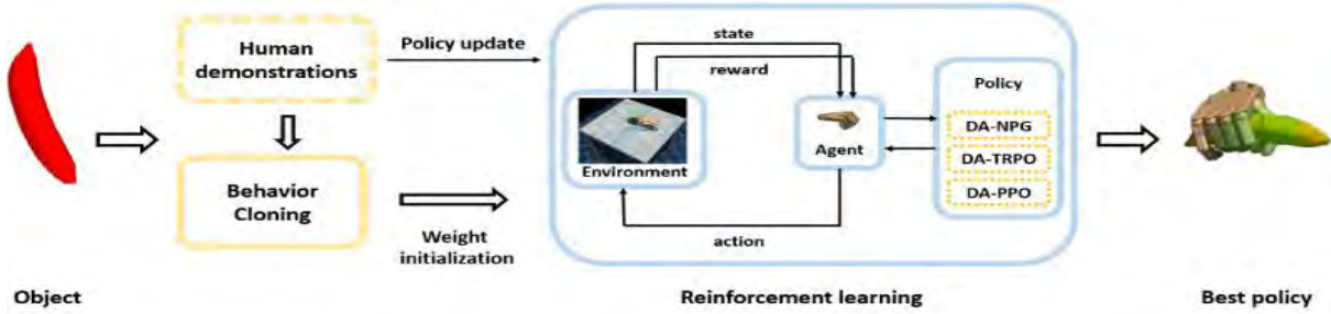
(그림 3) 로봇손 사물 조작(파지 및 재배치) 학습을 위한 전체 강화학습 과정.
