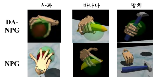
(그림 5) DA-NPG 와 NPG 학습 후 최종 사물 조작 작업 결과
