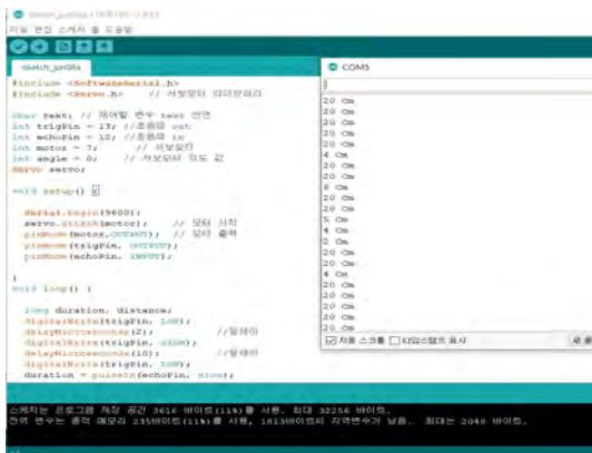
그림 7. 시리얼 모니터를 통한 자동 개폐 시스템 작동 상황 모니터링
