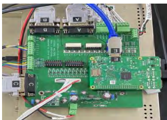
(그림 2) iCT 시스템 통합 임베디드 컨트롤러
