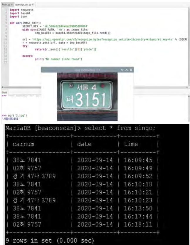
(그림 4) 차량 번호 추출 코드 및 DB
