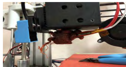
사진1 출력 실패로 인한 노즐 고장
