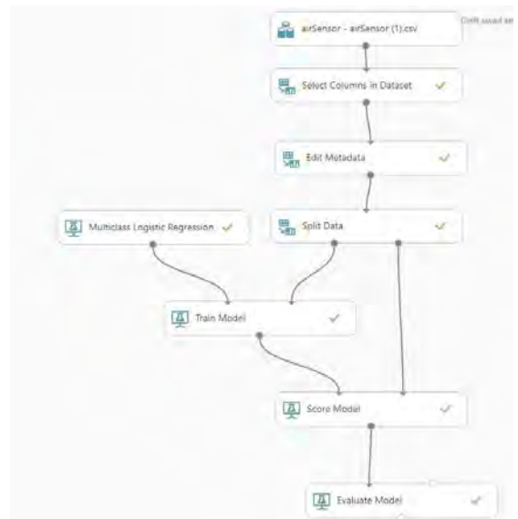
<그림 3. 미세먼지 센서 데이터 머신러닝 모델링 과정 - 다중 로지스틱 회귀 알고리즘 적용>
