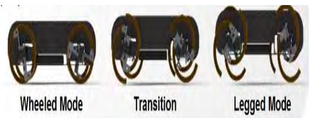
(그림 2) Turboquad 휠 변형 과정
