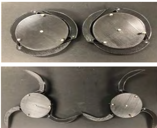
(그림 3) 일반적 Wheel(위)과 변형한 형태인 Legged-wheel(아래)
