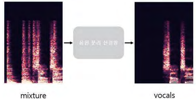
(그림 1) Spectrogram 방식의 신경망 기반 음원 분리.
